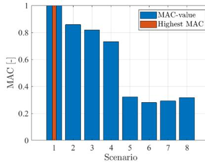
(c) Damage in location 1 (Single element) (d) MAC-distribution
